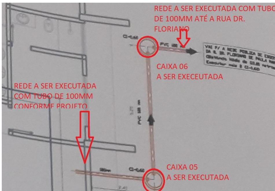
(NOTA: 175,26m - 45,86m executado = 129,40m A EXECUTAR DE TUBO PVC, SERIE NORMAL, ESGOTO PREDIAL, DN 100 MM, FORNECIDO E INSTALADO EM RAMAL DE DESCARGA OU RAMAL DE ESGOTO SANITÁRIO)
