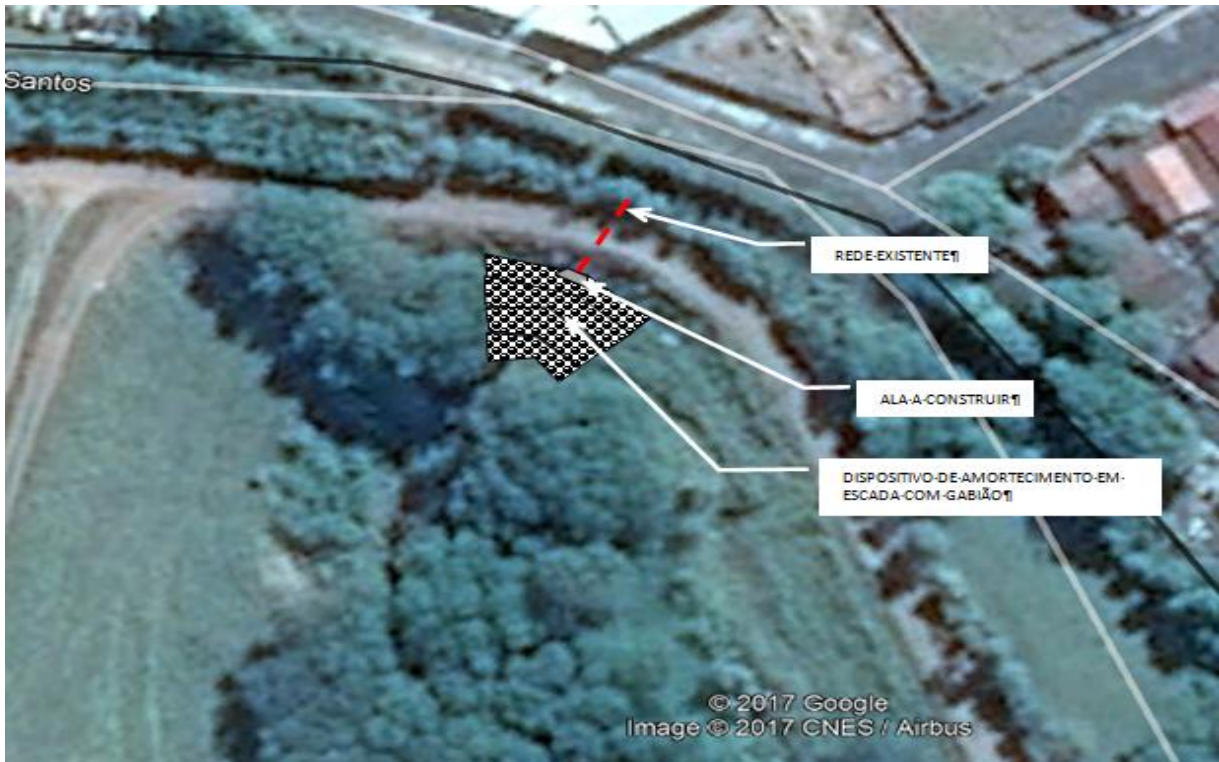
Ilustração 8.1 - Esquema da solução proposta para o Ponto 1.
