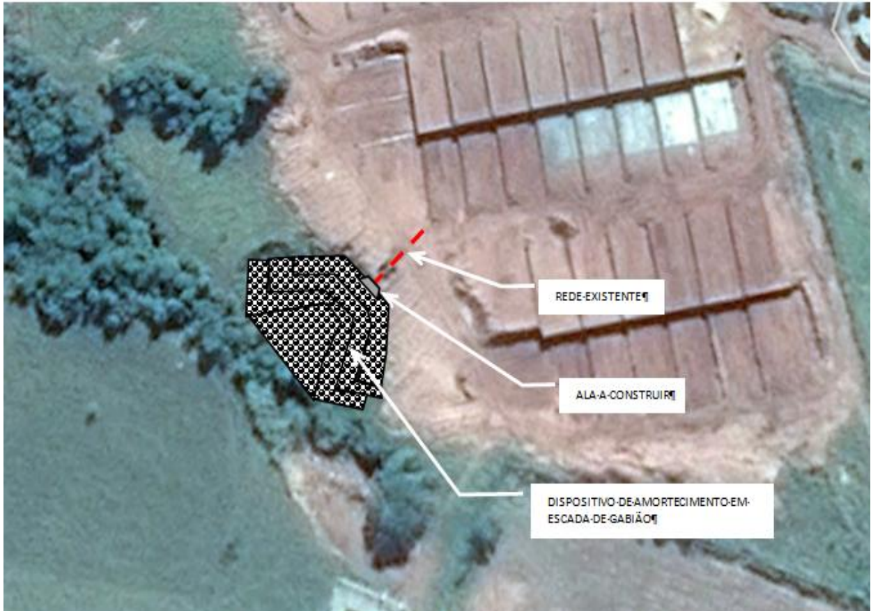
Ilustração 8.8 – Esquema da solução proposta para o Ponto 3.
